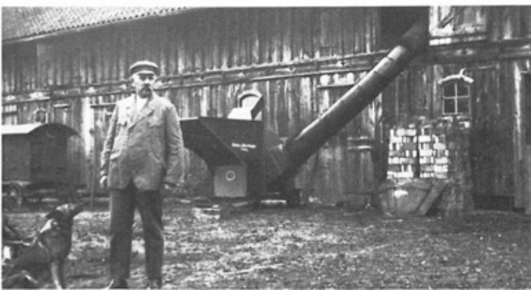
Kuhstall mit „Heupuster“ und fahrbarem Elektro-Motor. Im Vordergrund: Vater Harms im Jahr 1935.
